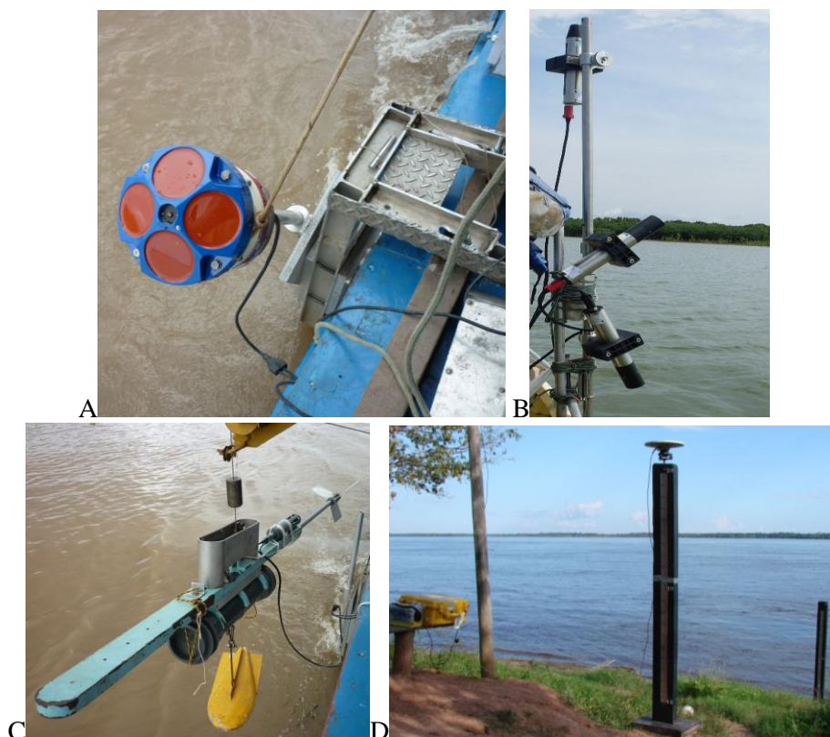
Figura 2. Equipamentos utilizados no trabalho de campo: A) ADCP Rio Grande 600 Khz, marca Teldyne RD Instruments; B) sistema de espectro-radiômetros Trios; C) Amostrador de água para determinação de sedimentos em suspensão e D) GPS para nivelamento de réguas.
