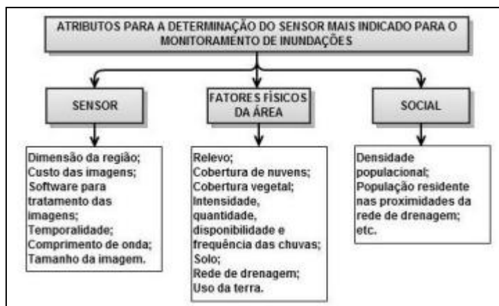
Figura 4. Diagrama evidenciando os atributos para a determinação do sensor mais indicado para o monitoramento de inundações.
